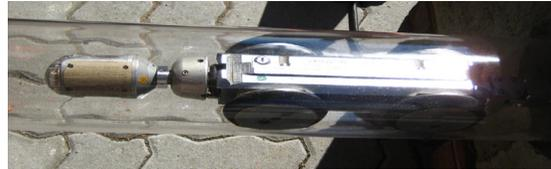
Bei einer TV-Inspektion werden spezielle Mini-Kameras in die Abwasserleitung eingeführt, um den Zustand der Leitung anhand der aufgenommenen Bilder zu beurteilen. Für die Untersuchung wird eine Inspektions- bzw. Reinigungsöffnung benötigt. Ist diese nicht vorhanden, sollte sie für zukünftige Wartungsarbeiten nachgerüstet werden. Zu einer ordnungsgemäßen Inspektion gehört eine vorherige Reinigung, damit der Zustand der Abwasserleitung sicher beurteilt werden kann.
